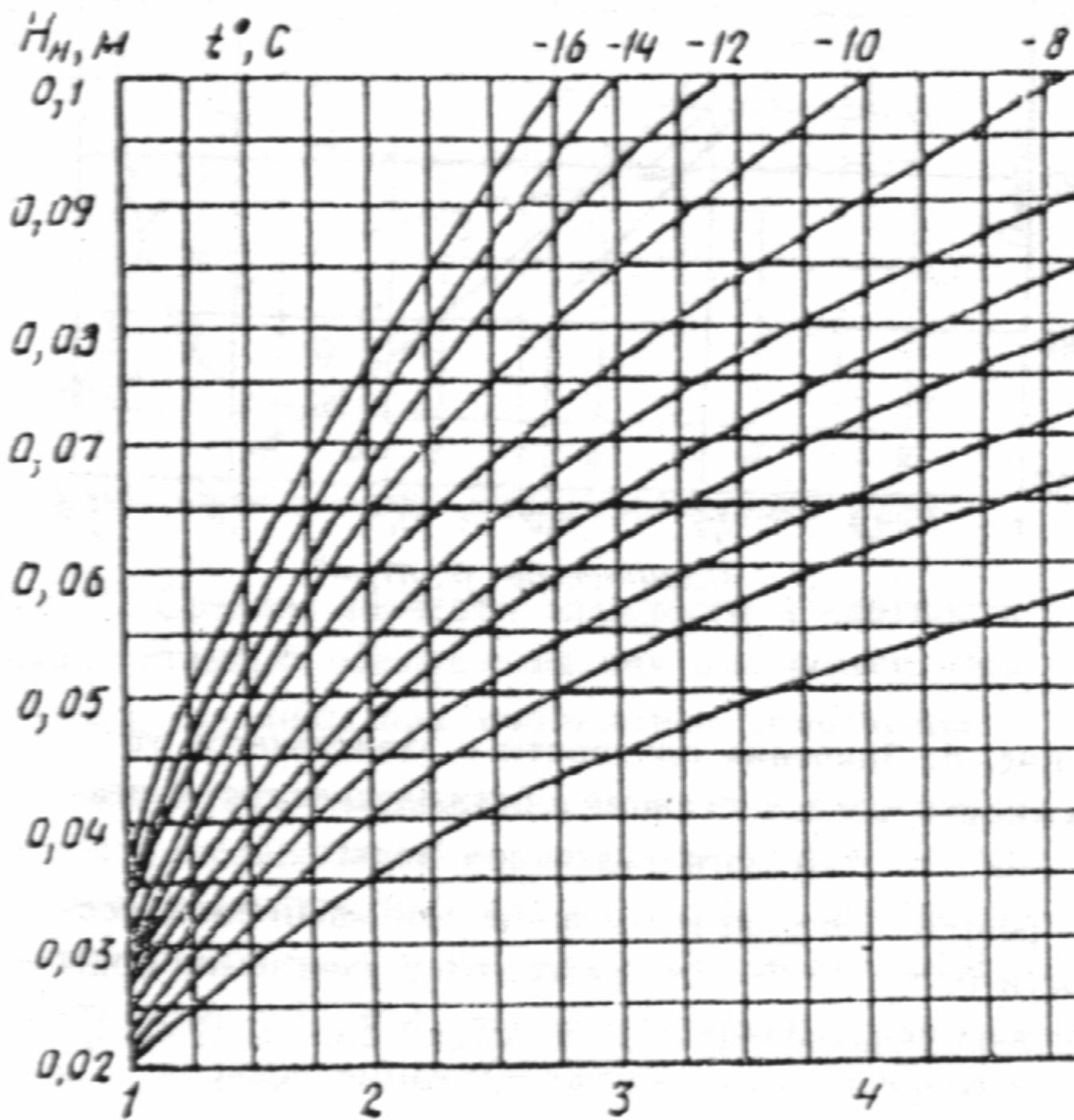
Рис. 7. Зависимость глубины промораживания слоя осадка от среднесуточной температуры воздуха и продолжительности промораживания
